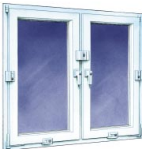
Verteilung von Sicherungen
